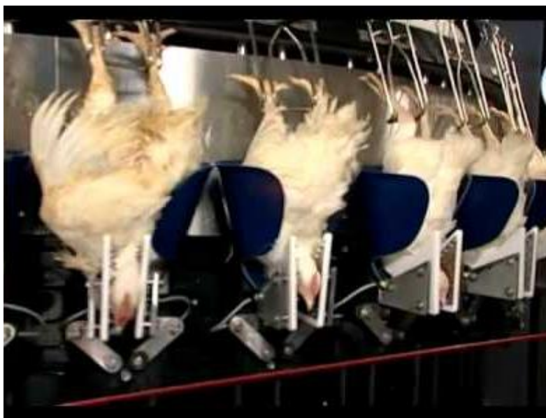
شكل (6) تدويخ الدجاج باستخدام الصدمة الكهربائية للرأس فقط
