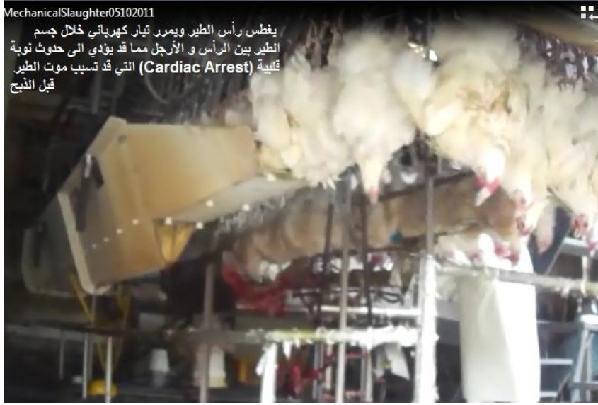
شكل 3 الحمام المائي المكهرب قد يعرض الطيور الى الموت جراء تعرض بعضهم الى نوبة قلبية
